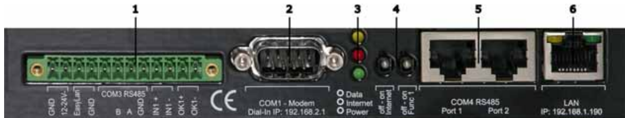
Abbildung 4-1 Anschlüsse des SOL.Connect Center
